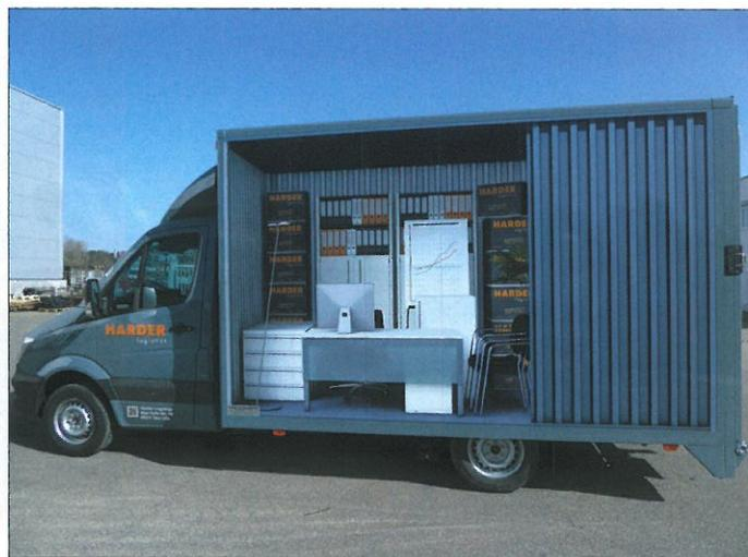
**Der Sprinter von HARDER logistics nutzt statt einer Hebebühne eine Auffahrrampe für Be- und Entladung. Die abgesenkte Ladekante sorgt für eine höhere Kapazität. HARDER logistics gewährt auf den Seitenwänden einen Blick in das Innere der Fahrzeuge.**
