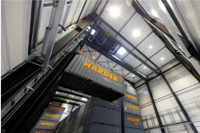
*Bildunterschrift: Kunden können 24/7 auf ihre Lagercontainer zugreifen, indem sie digital einen Slot für die Bereitstellung buchen. Der Container wird dann vollautomatisiert über einen Brückenkran zu dem gewünschten Zeitpunkt zum Übergabepunkt gebracht.*
